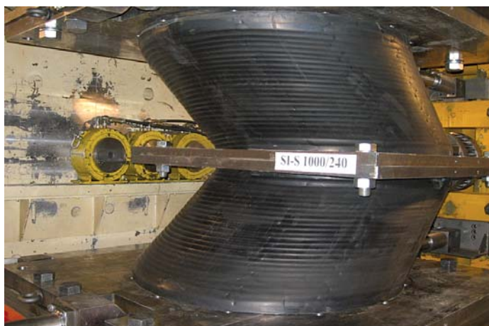
Test isolatori sismici del 1000 mm
